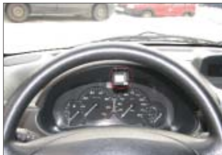
Фото. 1. Пример установки видеокамеры для контроля приборов
