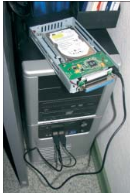
Фото. 3. Подключение Mobile Rack к ПК
